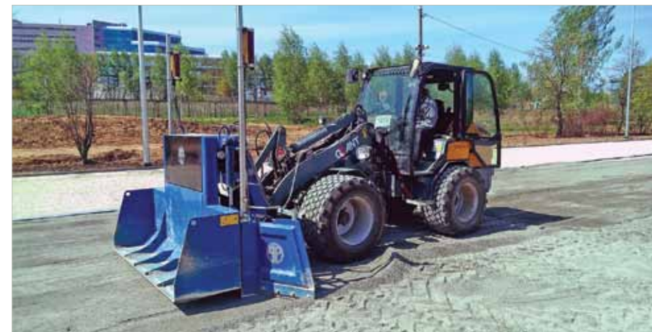
« Лазерный планировщик для вертикальной планировки.
