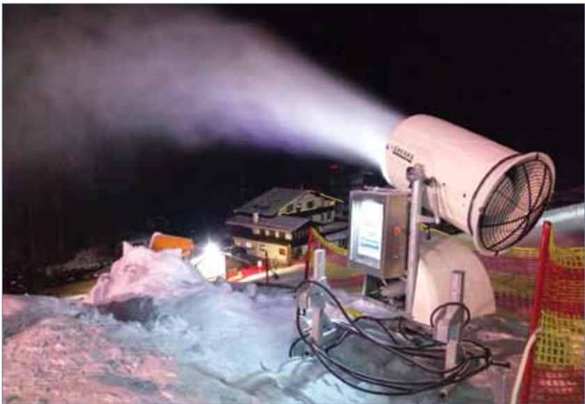
Ⓢ Снегогенераторы SHERPA. Ⓢ Блок управления.
