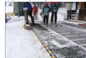
Посадочный конвейер с автоматической регулировкой по высоте
