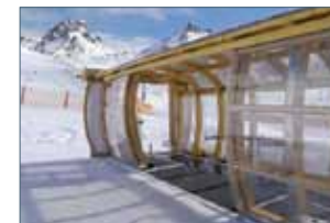
Посадочный конвейер для кресельных дорог с отцепляемыми зажимами
