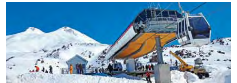
☉ Новейшая модель подвесных канатных дорог с 8-местными отцепляемыми гондолами производства французской фирмы «РОМА».
