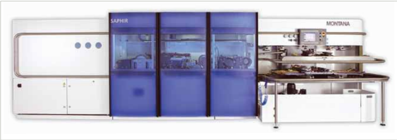
Автоматический станок-робот SAPHIR. Полный цикл подготовки лыж — шлифовка, нанесение структуры, заточка и тюнинг кантов, смазка и полировка.
