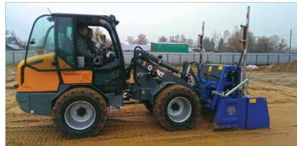
● Вертикальная планировка оснований спортивных площадок лазерным планировщиком.
