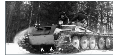
«Движитель гусеничный» на базе, которого был сделан первый российский ратрак. Кстати сказать который до сих пор на ходу и иногда используется
