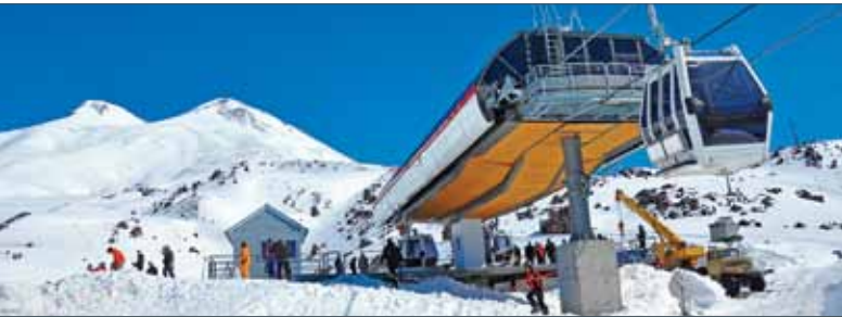
Новейшая модель подвесных канатных дорог с 8-местными отцепляемыми гондолами производства французской фирмы «РОМА»
