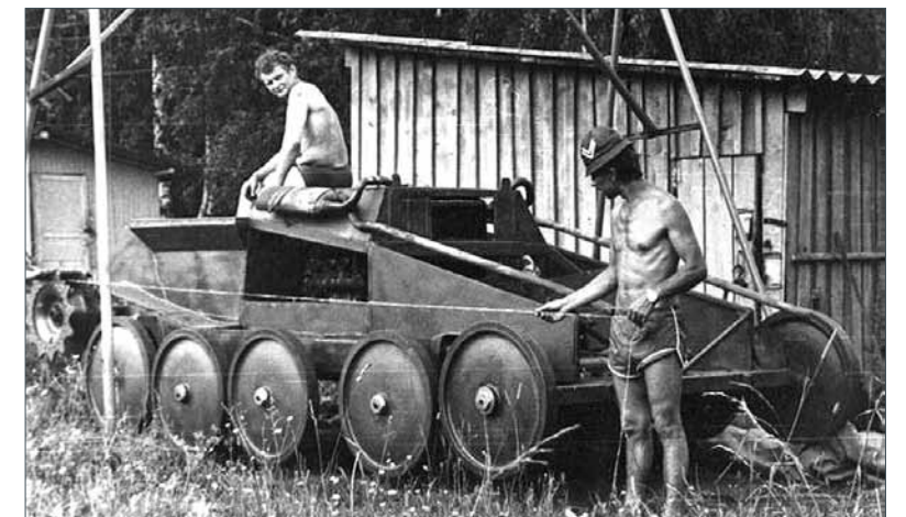
«Движитель гусеничный» на базе, которого был сделан первый российский ратрак. Кстати сказать который до сих пор на ходу и иногда используется
