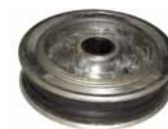
Ролик балансира шир. 40, 64 мм. Диаметр резинового бандажа 260 мм
